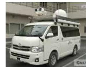
災害用移動体衛星通信実験システム車両 © NICT
