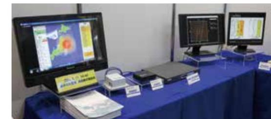
気象庁が配信する緊急地震速報を受信し、おおよその地震の到達時間や震度を、音声や専用表示器、サイネージや PC 画面等で案内します。画面上で日本地図を表示して、P 波・S 波の電波状況をリアルタイムで表示できます。また、既存の放送機器やエレベータ、自動ドア、工場ラインなどの制御機器を接続することも可能です。
