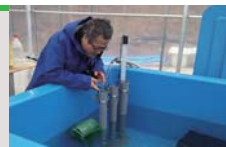
水槽に設置した水質センサー
