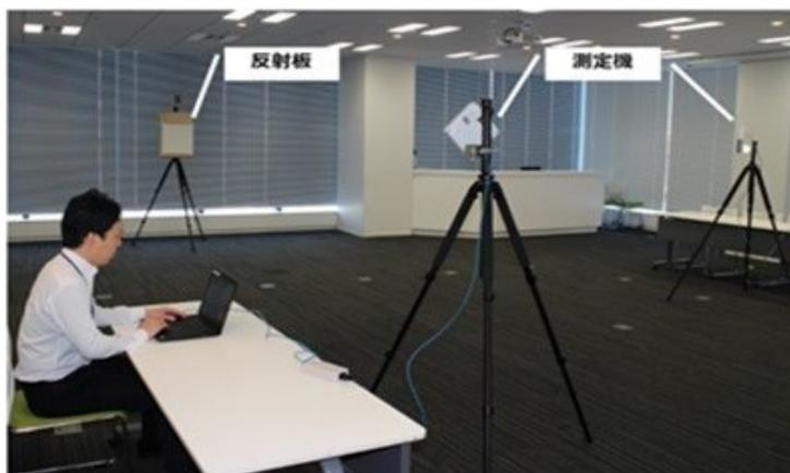
メタマテリアル反射板の基本的特性の測定の様子
